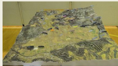
▲早大古谷研究室の皆さんによる「伊深模型」。標高データから等高線を切り出し、手作りで作りました。
